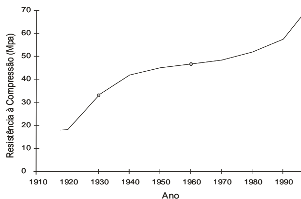
Figura 1 – Evolução das resistências médias à compressão do concreto aos 28 dias de idade. (Adaptado de Pomeroy, 1987 e de Neville, 1995)
